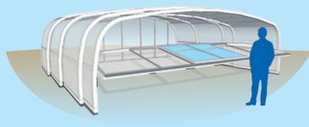
La façade basculante s'ouvre sur le même principe qu'une porte de garage de bas en haut. Abridays bascule à mi hauteur de l'abri, coulisse sur un rail et vient ensuite se plaquer sur la façade opposée. Cette solution permet d'ouvrir l'abri sur toute sa largeur sans entrave au sol et le bassin restant couvert. Cette façade équipe uniquement le modèle 85OT.
